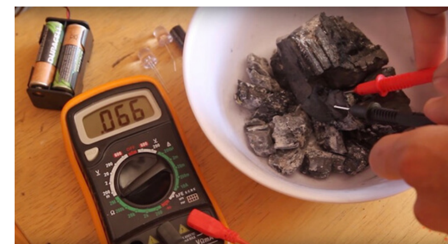
Le multimètre mesure la résistance du charbon. © Makerboat CC by SA 2.5
