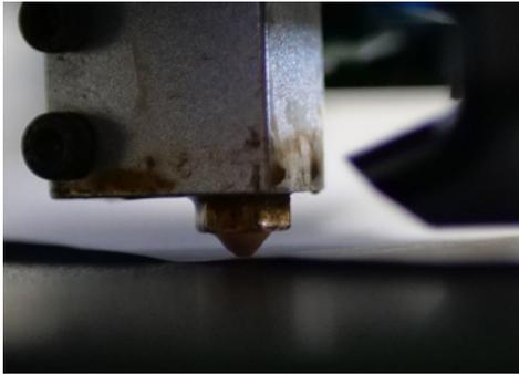
On va s'aider d'une feuille de papier classique pour cette étape. En cliquant sur 'first' ('première') la buse va se placer à un coin du plateau. La feuille doit pouvoir être déplacée entre le plateau et la buse avec un léger frottement (E).
